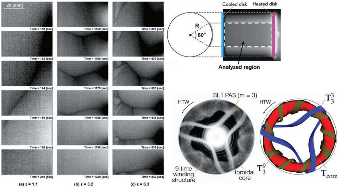
左: 国際宇宙ステーション日本実験モジュール"Kibo"で実現した, hydrothermal wave 不安定性に起因する液柱表面温度波の発展例 ( $\varepsilon$ : 1 次不安定性発現閾値からの距離に相当) (記事中文献[59]の図面を一部加工・説明追加). 右下: hydrothermal wave 不安定性に起因する液柱内に付加した粒子によるコヒーレント構造 (3.3 s 重ね合わせ) 記事中文献[73]の図面を一部加工・説明追加) (左) およびモデル対流場によって予測された Kolmogorov-Arnold-Moser (KAM) 環状体 (記事中文献[72]の図面を一部加工・説明追加). いずれも液柱上方から全体を投影, hydrothermal wave 不安定性によって一定角速度で回転している絶対座標系から回転座標系に変換している. (特集記事「温度差マランゴニ対流に関する研究 (上野 一郎)」より)
