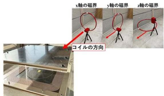
図 5 ループアンテナの三軸測定方法
