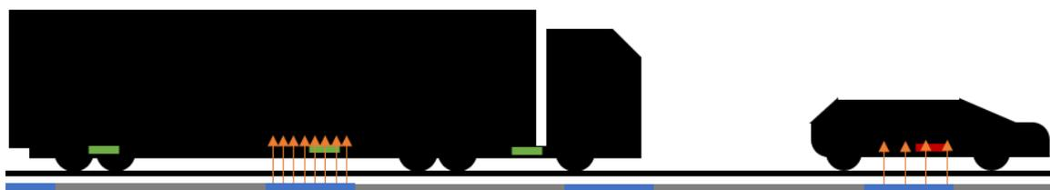
図5 同一の送電システムによる各車両へのワイヤレス電力伝送
