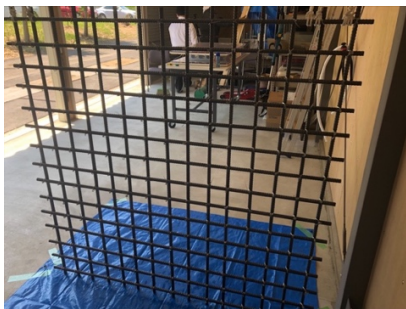
図 8: 使用した鉄筋
