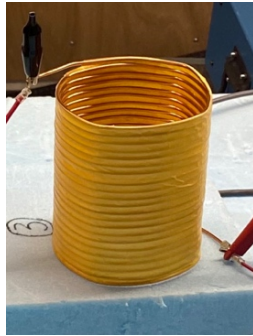
図 7: 作成した共振コイル
