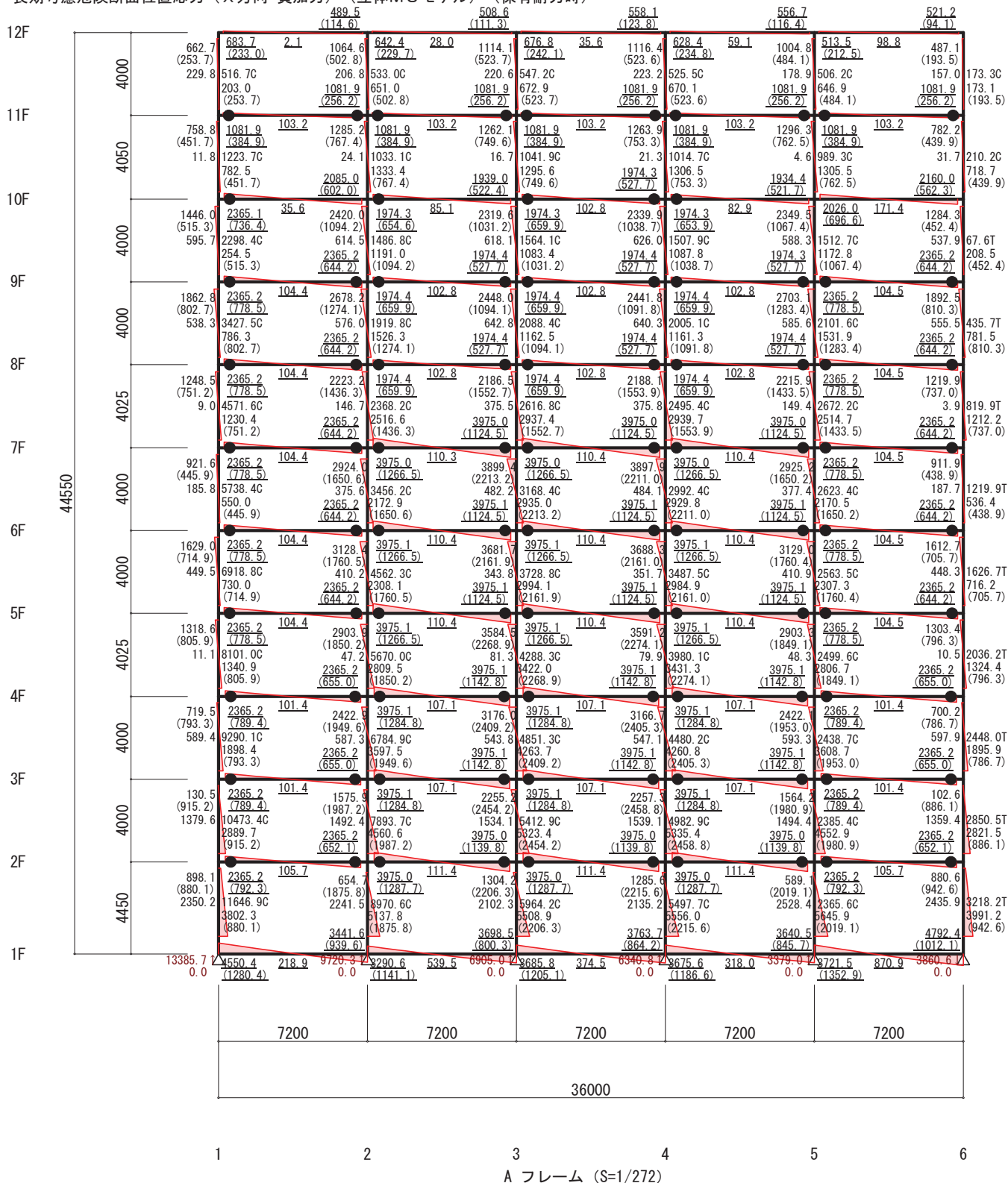
長期考慮危険断面位置応力 (X方向 負加力) (立体MSモデル) (保有耐力時)
