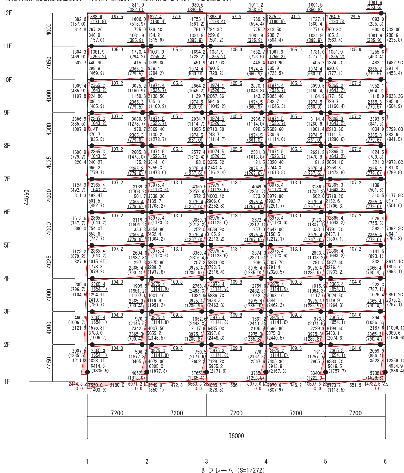
長期考慮危険断面位置応力 (X方向 正加力) (立体MSモデル) (Ds算定時)
