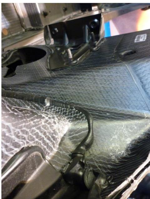
この写真、わかりにくいのですが、炭素繊維複合材料によるボディの成型写真です。部品と部品の継ぎ目には、溶接が適用できないため、接着剤を用いているそうです。現在、BMWでは電気自動車の開発に力を入れており、このため新しい素材とその加工技術は重要な研究テーマのひとつのようです。
