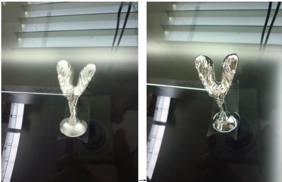
これ、何かわかりますか？ボンネットの先端についているエンブレムの製造工程です。精密鋳造のもと手仕上げでエンブレムを作製しているそうです。すごい！金属材料の加工技術の参考まで。
