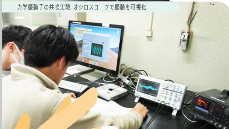
力学振動子の共鳴実験。オシロスコープで振動を可視化
