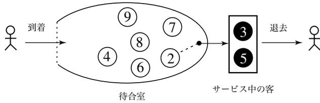
図 1.3.2 サービス順序比較のためのモデル (○の中の数字は到着の順番を表す)
