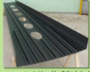
VaRTMにより一体成形されたMRJの翼構造
